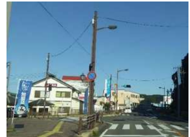
例：交通標識を既存の照明灯に備え付ける等、共架化を行うことによって雑然とした印象になることを避けることができる。
